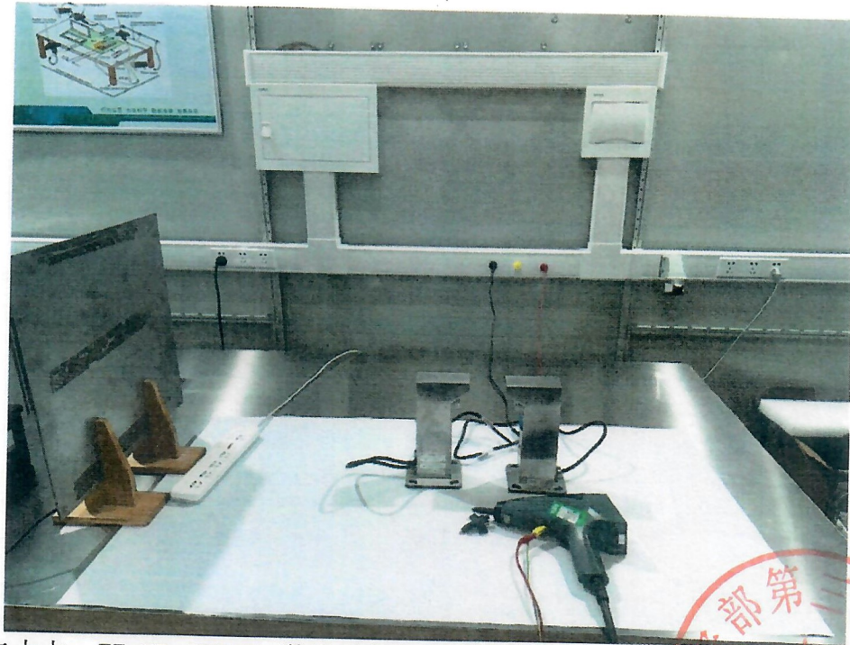
图二十七、FT-XD-JBBX01 激光对射入侵探测器 静电放电抗扰度试验现场照
