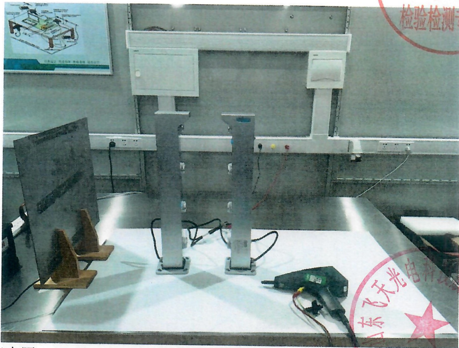
图三十四、FT-XD-JBLH04 激光对射入侵探测器 静电放电抗扰度试验现场照
