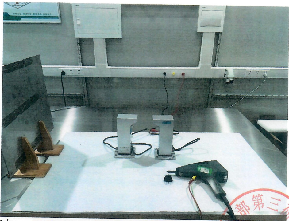
图三十一、FT-XD-JBLH01 激光对射入侵探测器 静电放电抗扰度试验现场照
