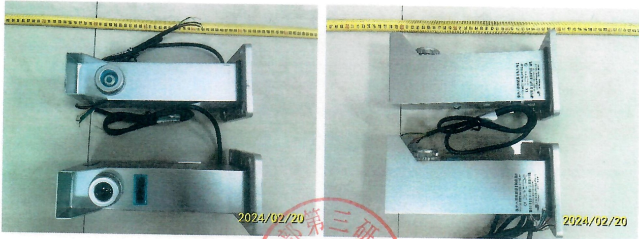
图十五、FT-XD-JBLH01 激光对射入侵探测器 外部结构
