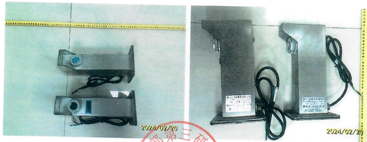
图七、FT-XD-JBBX01 激光对射入侵探测器 外部结构
